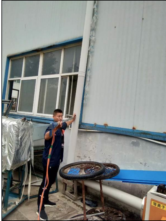
有机废气出气口采样
